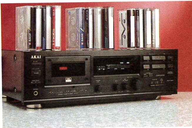
Le risposte in frequenza con i nastri di tipo I risultano, in generale, abbastanza regolari; più di tutti con la cassetta Basf Ferro Maxima, adatta anche come sensibilità. La Sony e la TDK richiedono un leggero incremento del bias mentre la Roxana una riduzione (Bias fine -1 tacca). I dati di rapporto segnale/rumore sono piuttosto elevati, in particolare con la Espir e con la Ferro Maxima.
