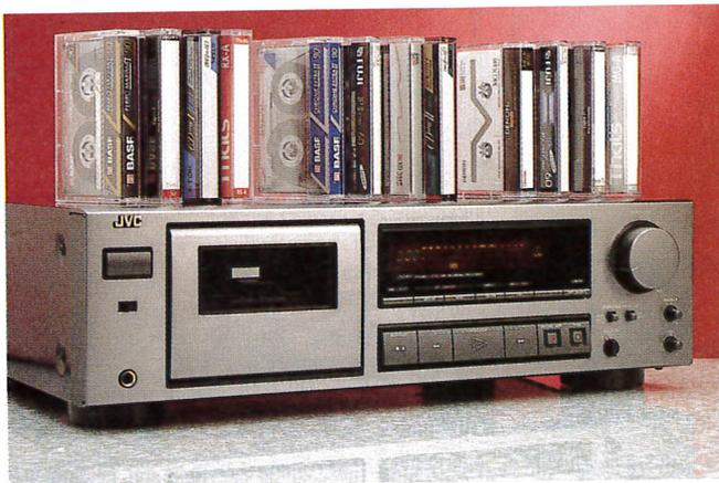
Con i nastri di tipo I il bias di taratura di questo registratore risulta un po' più basso del precedente. Ciò comporta un incremento delle altissime frequenze con ogni cassetta (in particolare con la Roxana, evidentemente più sensibile alle variazioni di bias) nonché una riduzione del MOL a 315 Hz e quindi dei rapporti S/R. La Ferro Maxima fornisce la risposta più lineare.
